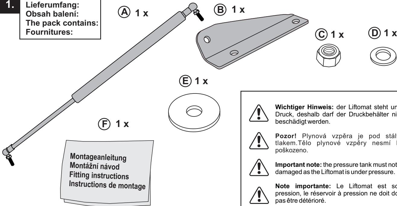
**Wichtiger Hinweis:** der Liftomat steht unter Druck, deshalb darf der Druckbehälter nicht beschädigt werden.
